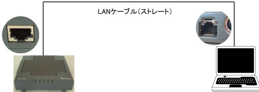
・ケーブルモデム背面のLAN差込口とパソコンのLAN差込口をLANケーブルで接続します。
